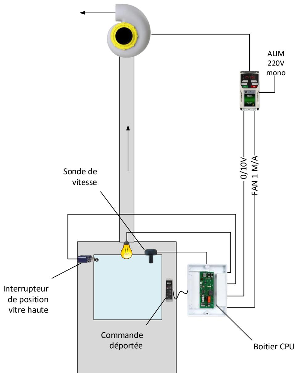
Le contrôleur de débit **type C déporté** permet de contrôler le débit d'air d'une sorbonne.
