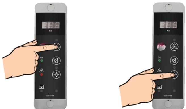
Un appui sur augmente la consigne 0/10v envoyée au variateur de fréquence
