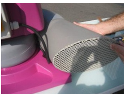
25. Placer le diffuseur sur la sortie de la volute et fixez-le avec 4 vis.
