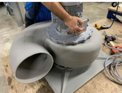
4. Retourner l'unité et installer le moteur sur la flasque moteur
