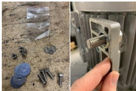
5. Insérer les 4 vis sur les pattes moteur et les bloquer avec des rondelle vistop
