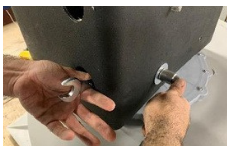
Utiliser les trous sur le coté du chapeau pour accéder aux boulons
