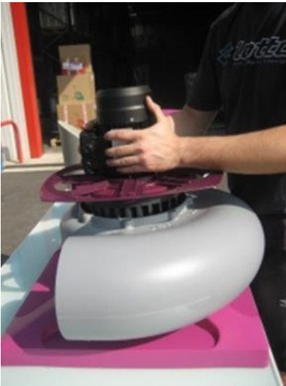
13. Insérer l'ensemble Moteur/Turbine.
