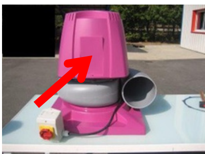
22-24. Fixer le commutateur avec les vis sur le côté plat du chapeau.
