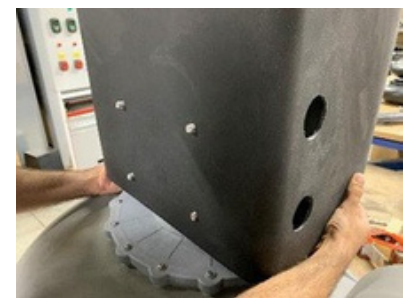
6. Placer le chapeau sur le moteur et faire correspondre les trous et les vis
