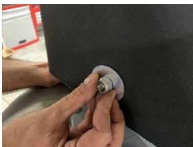
7. Visser les boulons avec les écrous et les rondelles
